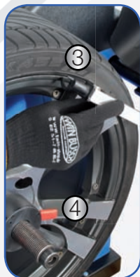
(1) Nauwkeurige positiebepaling van alle gewichten middels een elektronische meet arm (2) Laser positioneringssysteem (3) Meetarm voor het autom. bepalen van de randbreedte (4) Snelspanmoer Ø = 40 mm (5) LED-Licht (6) Grote en heldere TFT-kleurenmonitor (7) Gemakkelijke en snelle ingave op toetsenbord
