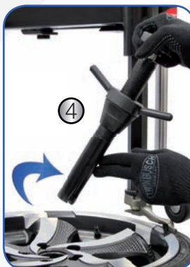
(1) Bras d'assistance supplémentaire (2) Tête de montage (3) Gonfleur intégré (4) Fixation de la jante par trou central, cône et pince de serrage rapide (5) Elévateur de roue
