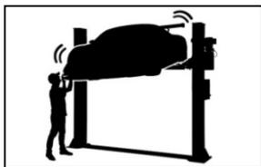
Éviter les fortes secousses sur le véhicule
