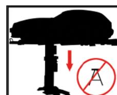
Aucun objet sous le pont élévateur lors de l'abaissement !
