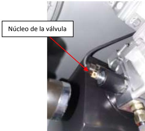
3. Gire el botón rojo de suministro de aire en la válvula neumática mientras gira el núcleo de la válvula en sentido antihorario para abrir la válvula. Al presionar la válvula, el elevador baja.
