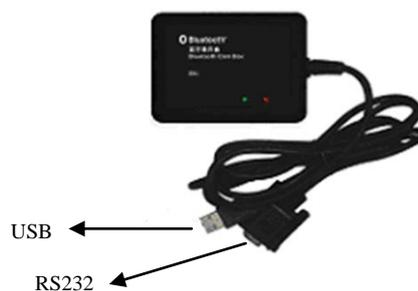
**Dispositivo de transmisión de datos mediante Bluetooth**
