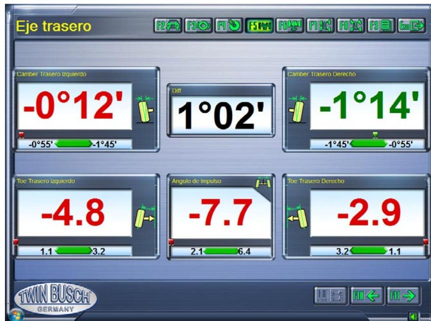
**Pantalla Alineación y ajuste del eje trasero**
