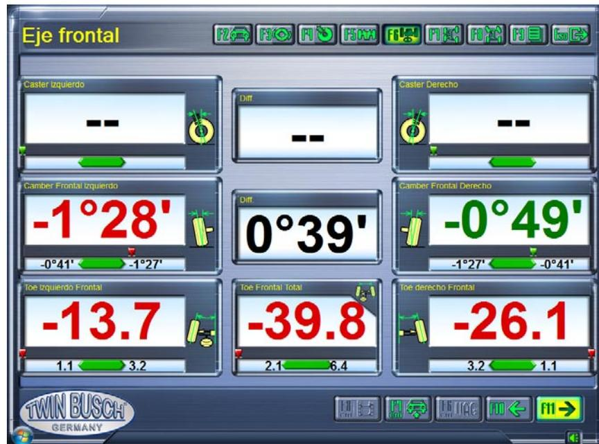
**Pantalla Alineación y ajuste del eje delantero**
