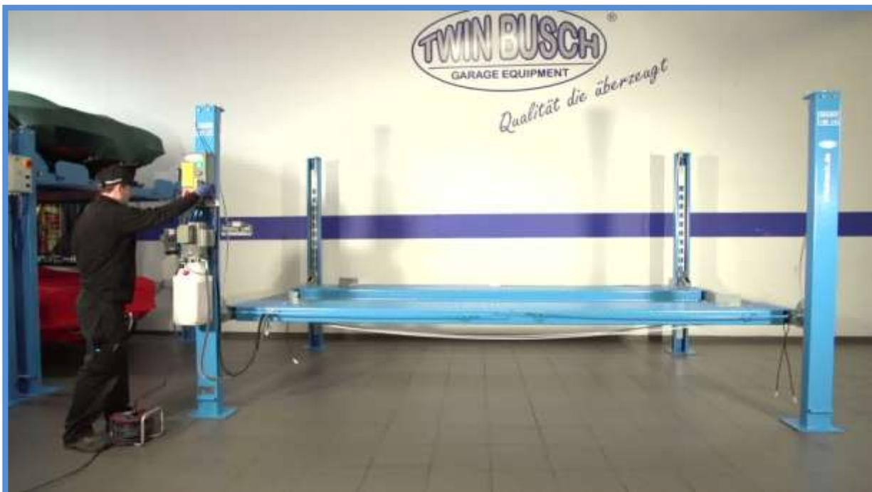
Ahora atornillamos desde abajo la varilla de desbloqueo manual. Tenga en cuenta que la palanca al principio y al final de la varilla de desbloqueo no debe girarse. Por esta razón, durante todos los trabajos de atornillado, asegure siempre la varilla de desbloqueo contra el giro involuntario con una llave de boca.
