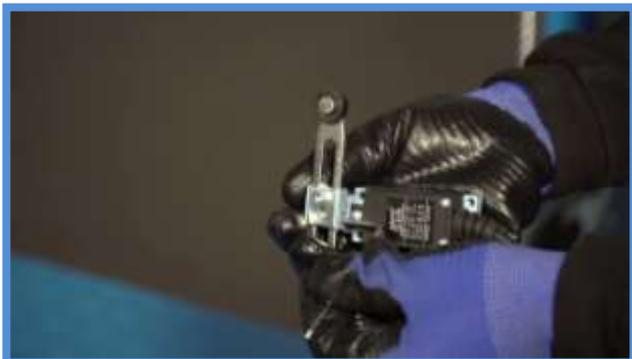
**Afloje el tornillo para ajustar la longitud del brazo del interruptor y deslice el brazo aproximadamente dos tercios de la longitud total hacia adelante.**
