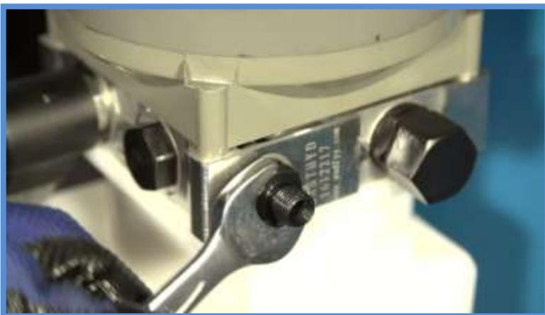
**Después retiramos la tuerca de la manguera que lleva al cilindro y la montamos con las arandelas en el orificio previsto para tal fin. Ahora se puede atornillar la manguera de aceite.**
