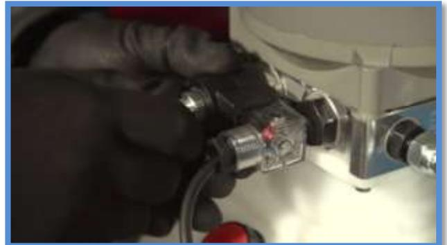
**El cable azul y el marrón son la fuente de alimentación del motor y se conectan con los cables con las letras W y U.**
