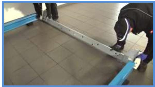
**En el paso siguiente, se introduce el travesaño adecuado en las columnas.
