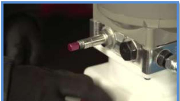
**Compruebe que la válvula de descarga esté correctamente cerrada. Si está abierta, ciérrala presionando el botón rojo y girándolo en sentido horario.**
