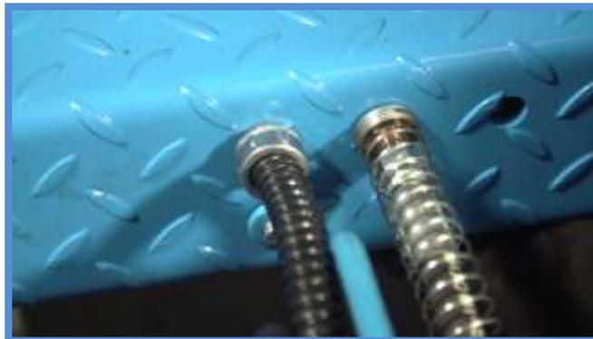
Ajuste el interruptor principal a encendido y controle que el botón de apagado de emergencia no esté activado; a continuación, accione el botón UP junto con el botón lateral para ignorar la protección contra cable flojo. Esto es necesario porque el interruptor de protección contra cable flojo todavía no está conectado con la caja de distribución en este momento. En el primer arranque el elevador tarda un poco en reaccionar porque primero debe comprimirse el aire del cilindro hidráulico.
