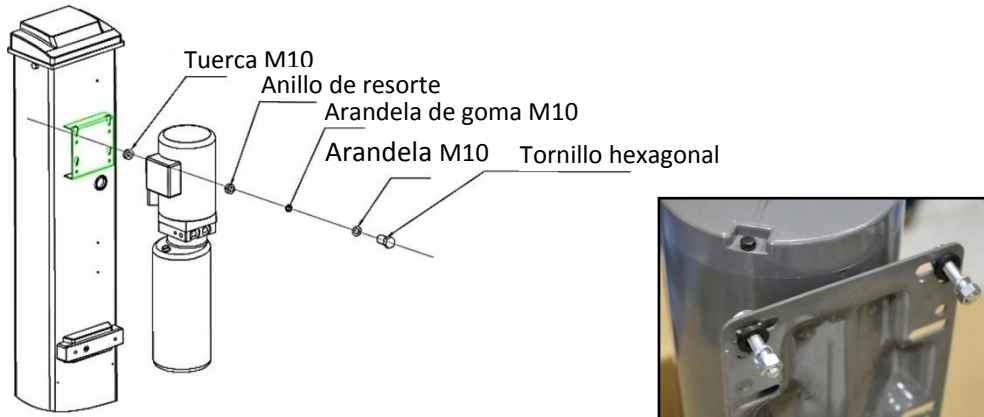
Ilustración 6: Montaje del motor
