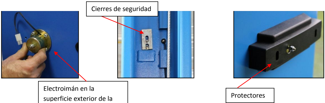
Ilustración 5: Conexiones de los bloqueos electromagnéticos
