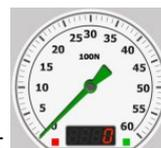
In dem Mitte die analoge Anzeige der aktuellen Bremskraft mit rotem und grünem Zeiger für linke und rechte Bremse.
