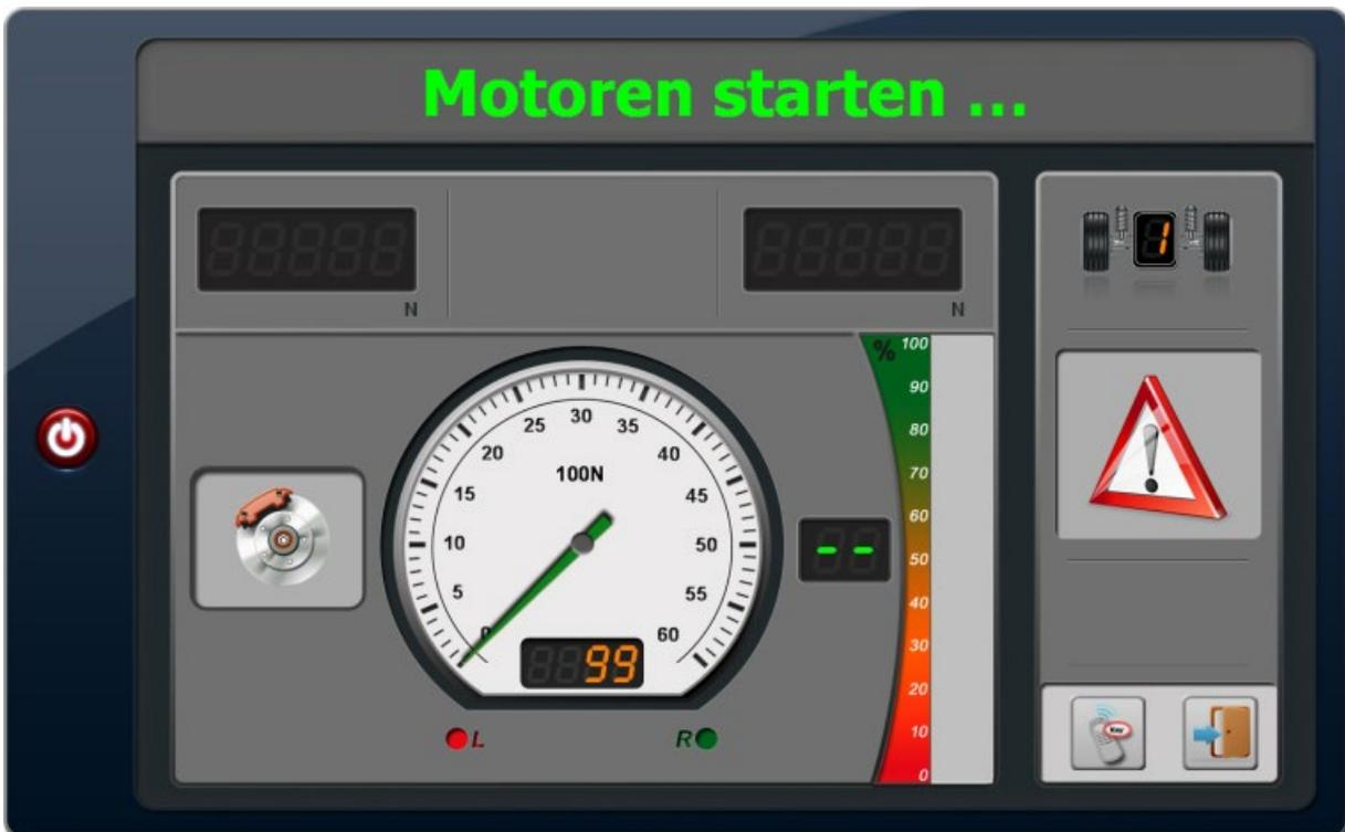
Motoren starten ... erst links, dann rechts um Spannungsspitzen zu vermeiden, in der Digitalanzeige erscheint die in Orange die Messung der Reibung zwischen Rad und Rolle.
