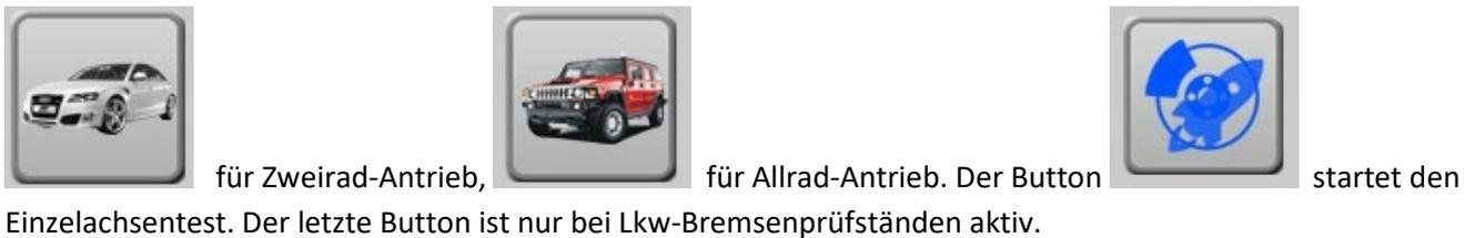
Beim Automatik-Modus wird davon ausgegangen, dass die Handbremse auf die Hinterachse wirkt. Bei Fahrzeugen mit der Handbremse an der Vorderachse muss diese separat in Einzel-Test Modus geprüft werden.
