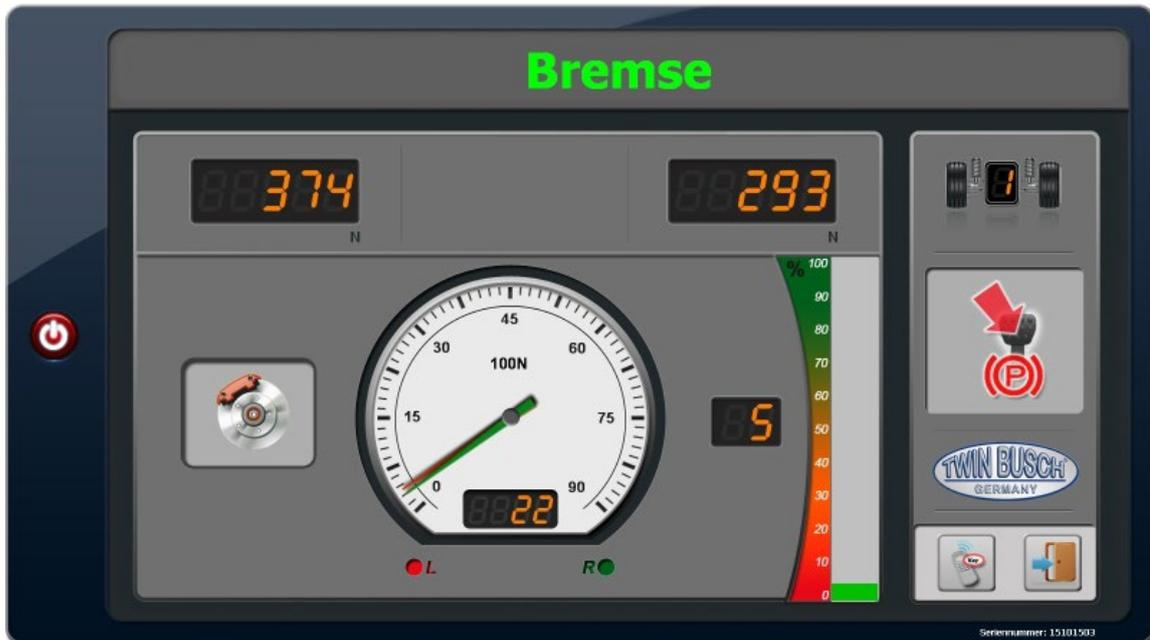
Nach Abschluss der Messung werden oben links und rechts die Messwerte digital angezeigt, die Zeiger (rot für links, grün für rechts) für analoge Anzeige.
