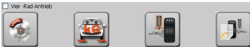
Hier kann man auswählen nur einzelne Tests durchzuführen, also nur Bremse, nur Gewicht, nur Stoßdämpfer oder nur Spurplatte.
